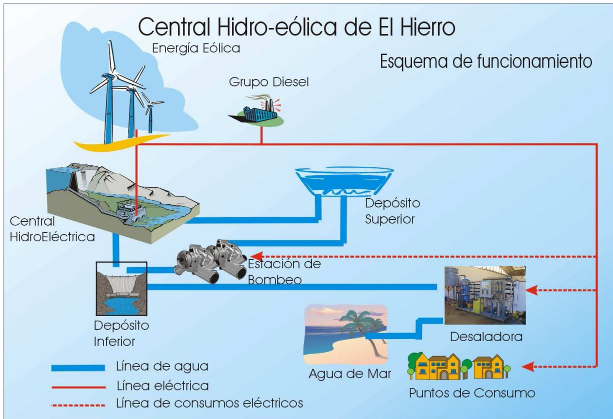
Fig. 1: Schema di funzionamento della centrale idroeolica dell'Isola El Hierro
